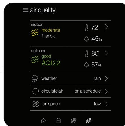
**L'écran de qualité de l'air\*** affiche les niveaux de qualité de l'air intérieur lorsqu'un dispositif de surveillance de l'air intérieur Daikin *One* est connecté. La qualité de l'air extérieur et la météo seront affichées si il y a une connexion à Internet et qu'un thermostat a été ajouté dans l'application mobile sous l'emplacement du domicile.
