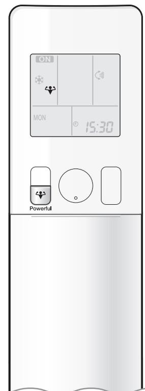
Le fonctionnement PUISSANT maximise rapidement l'effet de refroidissement (chauffage) dans n'importe quel mode de fonctionnement. Dans ce mode, le climatiseur fonctionne à sa capacité maximale.
